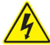
电机传动齿轮箱中载有危险电压，在飞轮旋转时以及断开交流输入前不得卸下外盖。即使飞轮在惯力耗尽后停转并且电源电压已关闭，该高压仍然存在。飞轮必须处于零（0000）转/分钟，并且必须断开交流输入电源至少 10 分钟，然后才能对电机传动齿轮箱进行任何维修工作。
